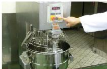
ホールド・トゥ・ラン制御装置（可動式覆いを開いた状態のときでも、ボタンを押している間に限り、低速で回転する。）を有するミキサー
