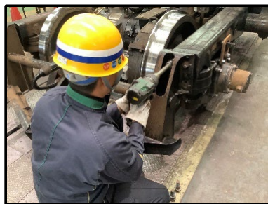
台車枠の組立作業
