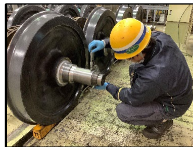
輪軸の検査作業
