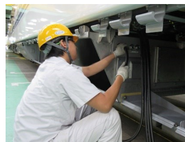
車両製造イメージ (配線配管作業)
